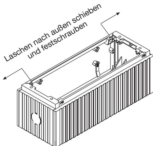
4. Hochwasseraufsatz aufsetzen und mit beiliegenden Winkeln Sechskantschrauben samt Muttern und Scheiben verschrauben.
