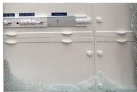
zerbrochene Scheibe aus Einscheiben-Sicherheitsglas (ESG)
