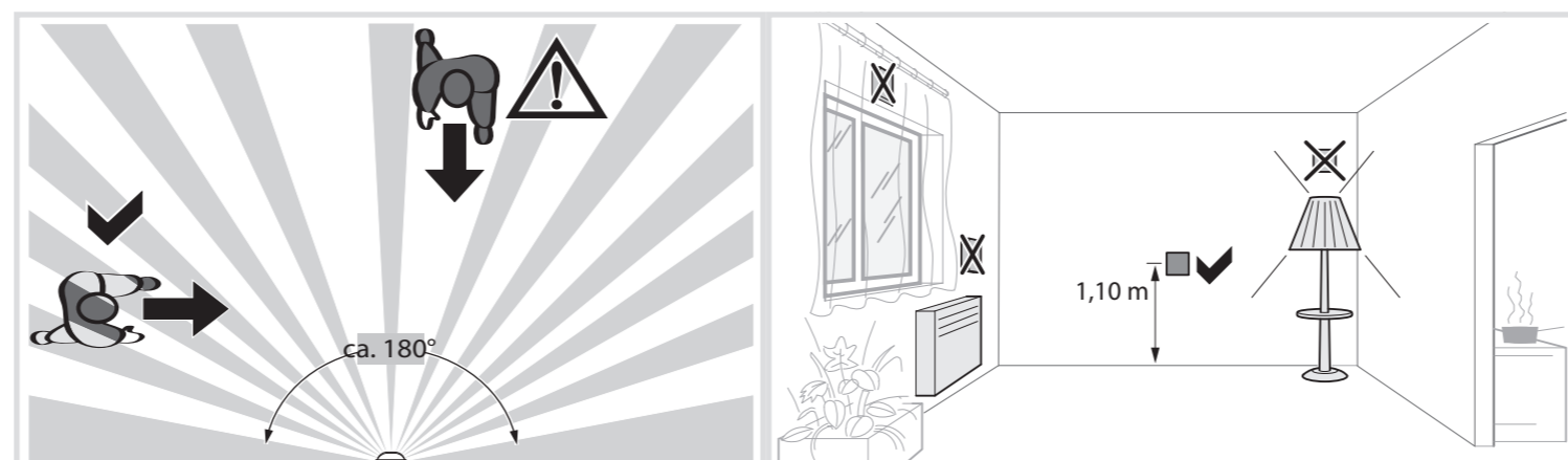
Figura 4: Luogo di montaggio di rilevatori di movimento e direzione di movimento
