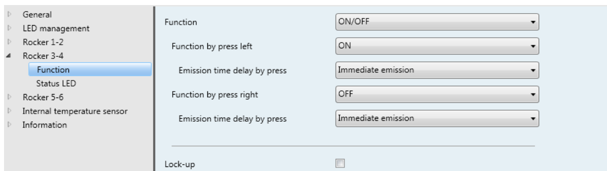
Bild 17: Vippströmställarens (vippströmställarnas) funktionssätt
