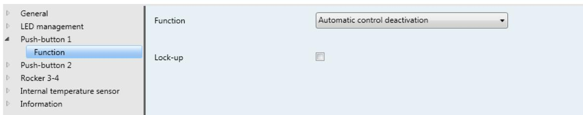
Figura 31: Parámetro "Desactivar funciones automáticas"
