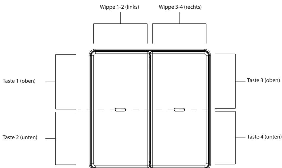
Figura 14: Pulsador de acoplador de bus de 2 elementos
