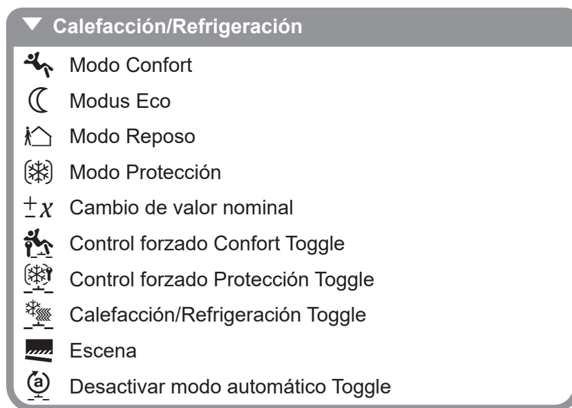
Figura 57: Vista general de las funciones Calefacción/Refrigeración
