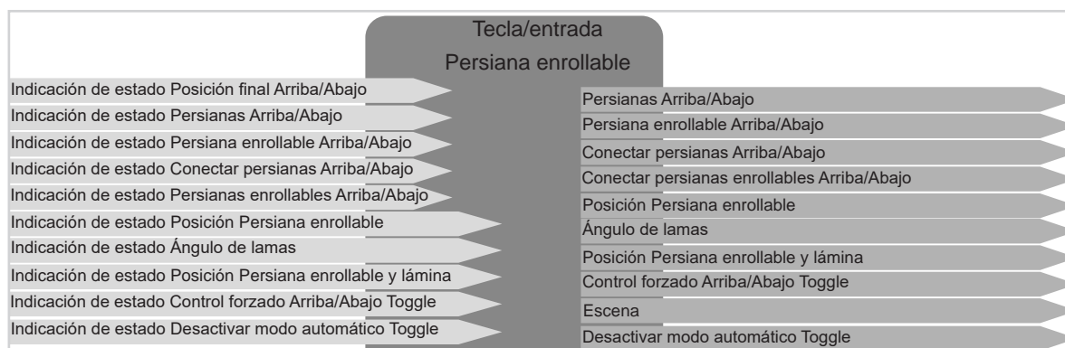
Figura 8: Señales de entrada/salida Función Persiana enrollable
