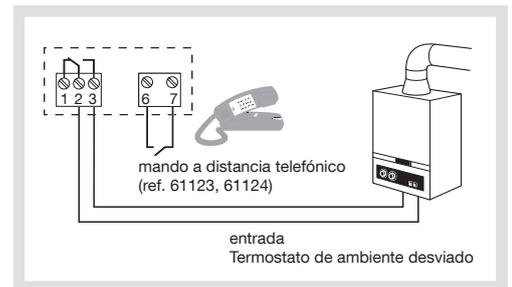
**Conexión del termostato a una entrada termostato de una bomba de calor (PCA) reversible o no**
