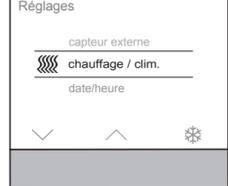
Figure 9 : Sélection fonctionnement chauffage/climatisation
