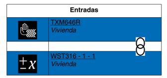
La activación de la entrada mediante una pulsación corta provoca el aumento o la disminución de X grados la temperatura de consigna del termostato.
