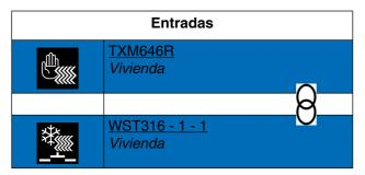
Cierre del contacto de entrada: activación del modo calefacción.
