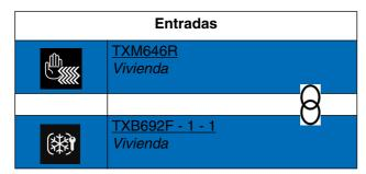
El cierre del contacto provoca la activación y la conservación del modo Protección. La apertura del contacto provoca la anulación del forzado y la vuelta al modo normalmente activo.
