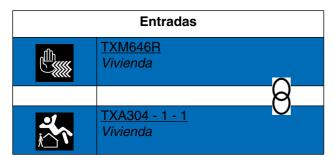
El cierre del contacto de la entrada provoca la activación del modo Confort. La apertura del contacto de la entrada provoca la activación del modo Suspensión. Cualquier otra orden de activación de modo anula el efecto de la orden.
