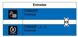
El cierre del contacto de la entrada provoca la desactivación del automatismo. La apertura del contacto de la entrada provoca la activación del automatismo.
