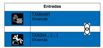
El cierre del contacto de la entrada provoca la activación del modo Protección. La apertura del contacto de la entrada provoca la activación del modo Auto. Cualquier otra orden de activación de modo anula el efecto de la orden.
