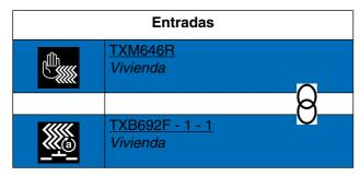
El cierre del contacto de la entrada provoca la activación del modo de calefacción 1. La apertura del contacto de la entrada provoca la activación del modo de calefacción 2. Cualquier otra orden de activación de modo anula el efecto de la orden.
