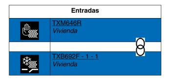
El cierre del contacto de la entrada provoca la activación del modo calefacción. La apertura del contacto de la entrada provoca la activación del modo refrigeración.
