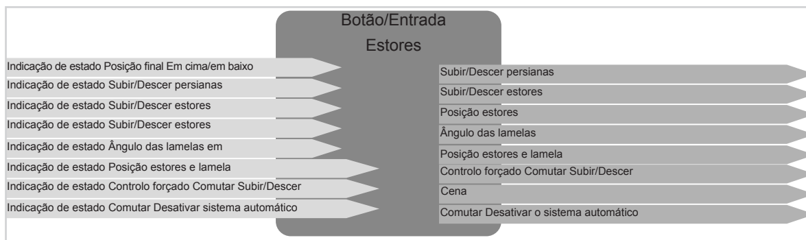
Figura 6: Sinais de entrada/saída Função estores
