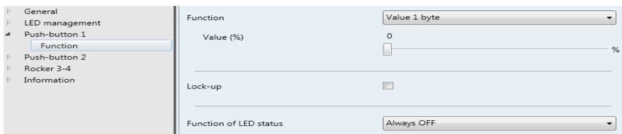
Figura 21: Función de la tecla basculante "Valor 1 byte"
