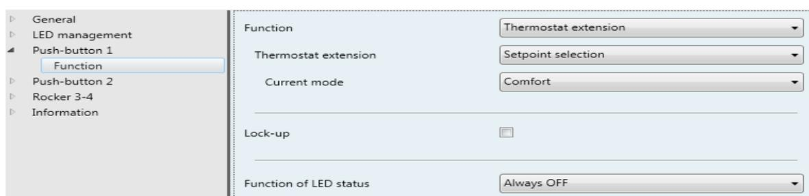
Figura 23: Función de la tecla individual "Estación supletoria para termostato ambiente"
