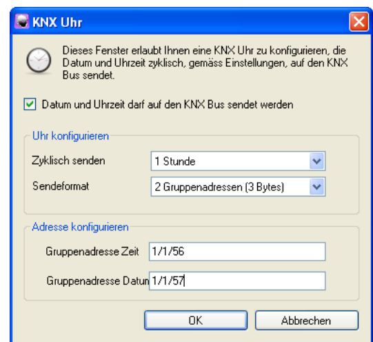
2 KNX-Adressen eine für das Datum (3 Bytes) und eine für die Uhrzeit (3 Bytes)
