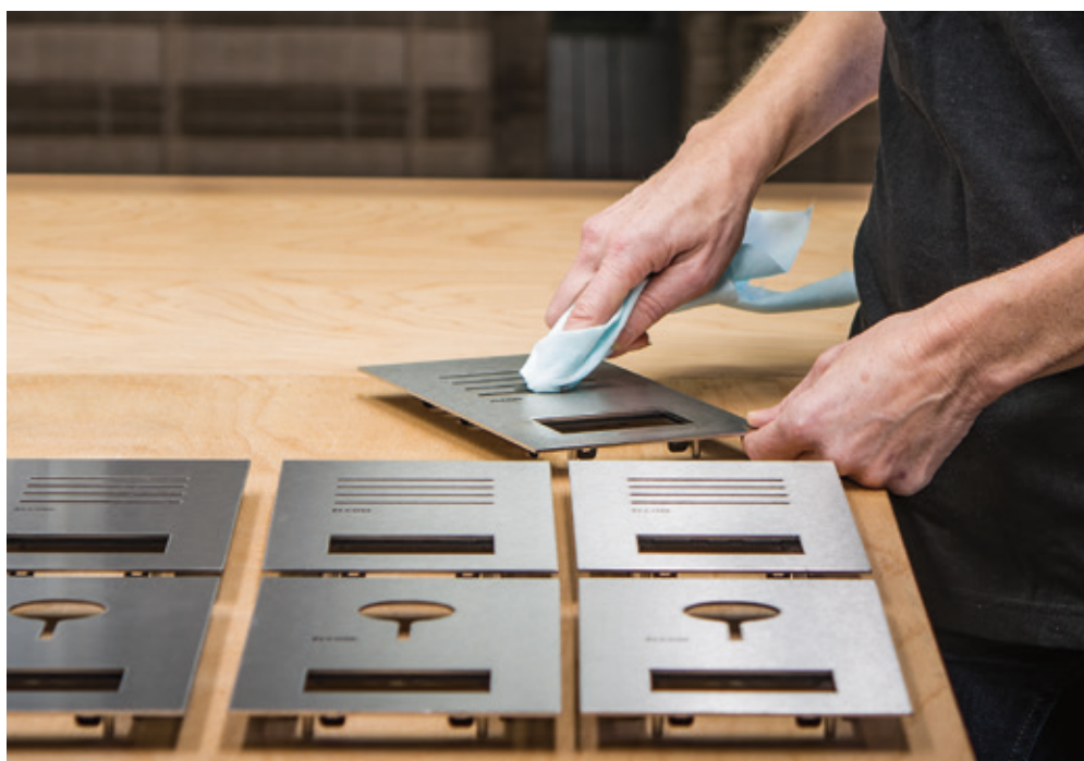
Abb.: Frontblenden von Elcom nach der Laserung.
