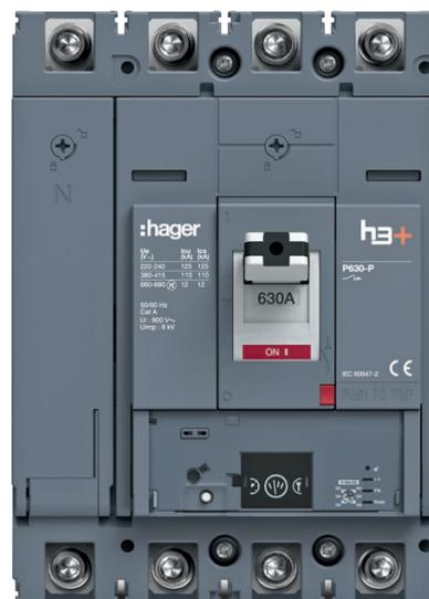
Die neue Generation der kompakten Leistungsschalter h3+ ist in drei Baugrößen erhältlich: P160 mit einem Nennstrom von bis zu 160 A, P250 mit einem Nennstrom von bis zu 250 A und P630 mit einem Nennstrom von bis zu 630 A. Alle drei Baugrößen stehen mit verschiedenen Auslöseeinheiten zur Verfügung.
