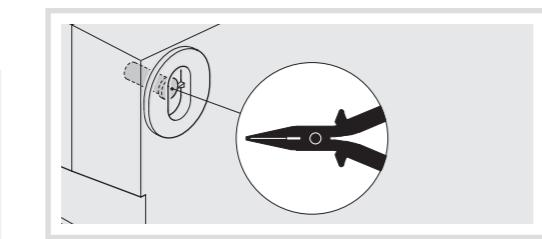
2. positionner le bouton de réglage bien en face d'une valeur (30 °C par exemple) et le déclipser.
