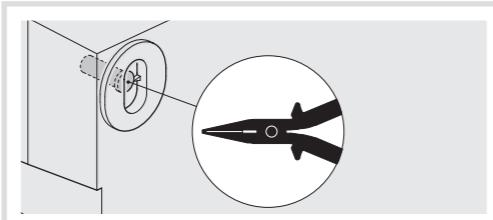
2. den Einstellknopf genau auf den gewünschten Temperaturwert platzieren (z. B. 30 °C) und abziehen.
