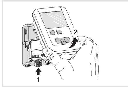
2. Aprire l'alloggiamento servendosi di un cacciavite e fissare la base a parete con le viti.
