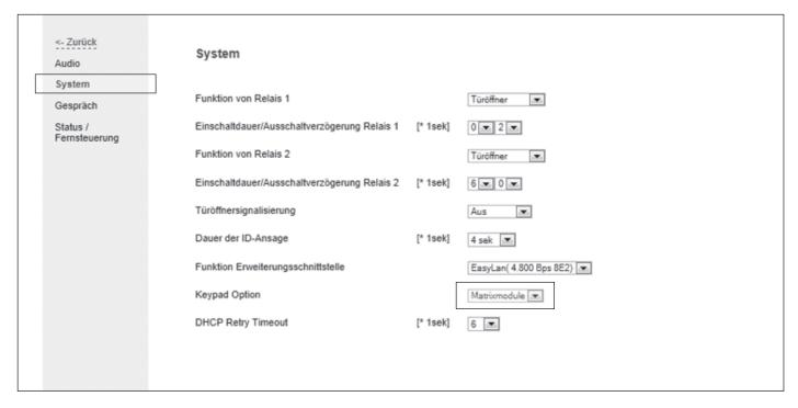
Um das Türsprechmodul LBM-300 für den Betrieb mit dem Direktwahl-Tastaturmodul einzustellen, muss in der Türsprechmodul-Konfiguration unter: Einstellung Hardware >>> System >>> Keypad Option auf "Matrixmodule" gestellt werden.
