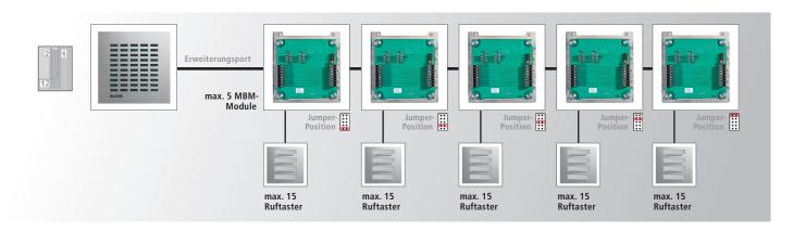
Anschluss Türsprechmodul LBM-300 bei erstem Diodenmatrix-Modul oder vorhergehendes Diodenmatrix-Modul bei Kaskadierung
