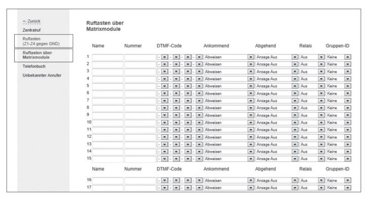
Die Teilnehmer 1 bis 60 werden aufsteigend im Telefonbuch-Menü des Türsprechmoduls unter: **Ruftasten über Matrix-Modul** eingetragen. Die Teilnehmer 61 bis 75 aufsteigend unter **Ruftasten (Z1 - Z4 gegen GND)**.
