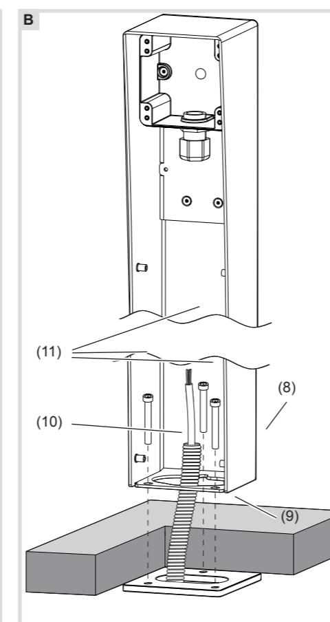
■ Fare passare il tubo di protezione con linea di alimentazione (10) attraverso la piastra di montaggio (9).
