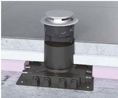
Für eine einfache Montage in Estrichböden bietet sich das kostengünstige Schalungselement aus halogenfreiem Kunststoff an: Dieses wird vor dem Gießen des Estrichs auf dem Boden ausgerichtet und nach Erreichen der Estrichfestigkeit wird der überstehende Teil einfach abgetrennt.
