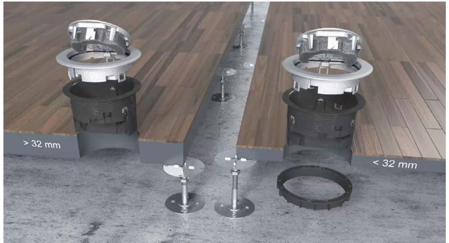
Für den Einbau in Systemböden sorgen integrierte Befestigungswinkel an der Installationsdose. Ein spezieller Klemmring aus dem Zubehör dient der Befestigung an dünnen Bodenplatten (Spannbereich < 32 mm).
