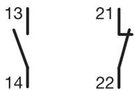
**Hilfsschalter für FI-Schutzschalter 10 kA Typ A, Typ F und Typ B**
