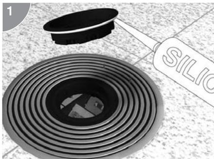
Bei der Versorgungseinheit muss nach dem Einkleben des Bodenbelages die untere Fläche des Belagrahmens vom Polyamid-Tubus mit geeignetem Dichtungsmaterial versehen werden.
