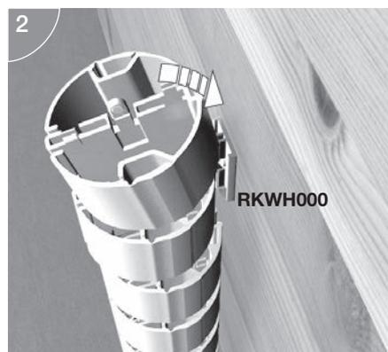
Rundkettenglied mit der Seite an der die Führungsnut eingebracht ist, von oben an den Wandhalter einführen.
