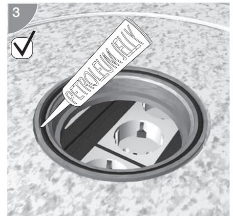
Nach dem Herausschrauben des Tubus-Deckels überprüfen, ob sich die Gummidichtung im Tubus-Montagesatz befindet und nicht fälschlicherweise am Tubus-Deckel haftet. Die Gummidichtung sollte in regelmäßigen Abständen mit Vaseline eingefettet werden.
