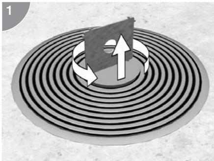
Beim VAN mit Aluminium-Tubus den Aluminium-Tubusdeckel mit dem Stirnlochschlüssel TUS000 aufschrauben und entnehmen. Deckel der Versorgungseinheit kann nun geöffnet werden, indem mit der Hand in die Öffnung gegriffen und nach oben gezogen wird.
