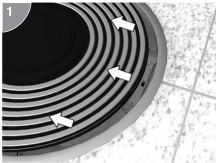
Zur Erleichterung der Montage kann optional die Deckelklappe vom Rahmen getrennt werden. Klappe öffnen und entgegengesetzt zum Scharnier ziehen. Dadurch werden die Schrauben vom Befestigungsset und ein Langloch am Scharnier zugänglich.
