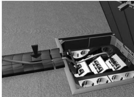
Stecker in die Steckdosen einstecken. Anschließend das Kabel von oben in die Flachkette eindrücken. Seitliche Perforierung des Flachkettengliedes lässt sich herunterdrücken.
