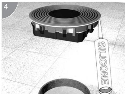
Die untere Fläche des Belagrahmens mit geeignetem Dichtungsmaterial versehen.
