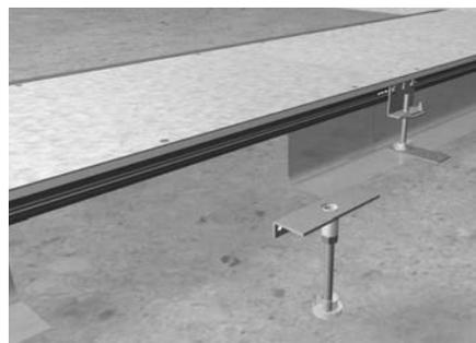
Nivellierstift mit Mutter BKZKM80 und Dämmhalter BKZNSD0 versehen. Nivellierstift in Stützwinkel einschrauben.
