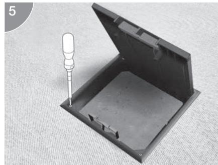
Innenliegende Schrauben der Befestigungssets über Kreuz andrehen (Kreuzschlitz H2).
