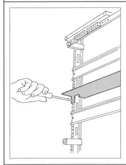
Schrauben Sie die Abschottung mit 2 Kerbschrauben mittig zwischen den Gerätetragschienen auf den Stahl-Schienen fest.
