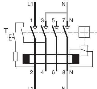
**Back-up beveiliging aardlekschakelaar / voorgeschakelde beveiliging zie Algemene Catalogus Hager.**
