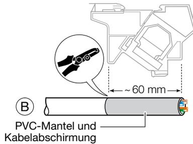
Abschirmung der Kabeladern (den Bezugspfeil nach vorne verschieben zu den einzelnen Adern)
