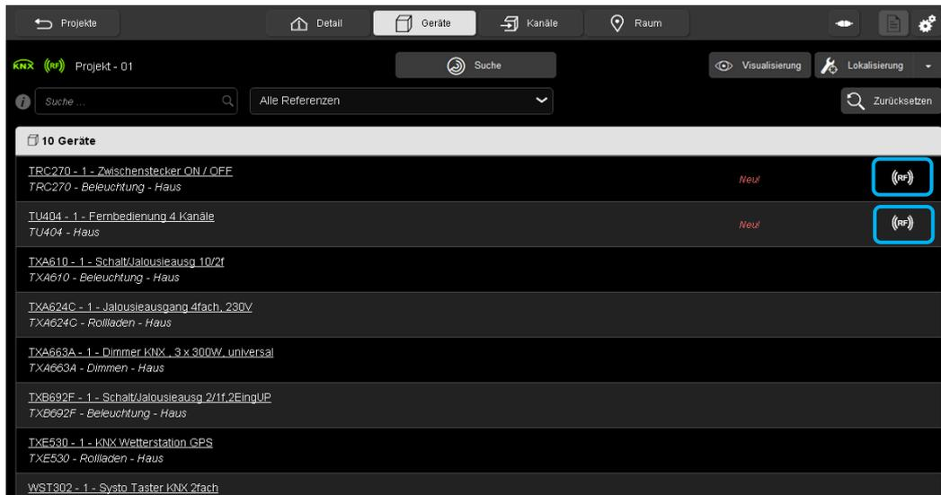
Bei der Gerätesuche werden die Funkprodukte erkannt. Die Kennzeichnung "RF" zeigt an, dass es sich um ein Funkprodukt handelt. Die Parametrierung des Produkts und die Verlinkung verläuft wie bei drahtbasierten Produkten.
