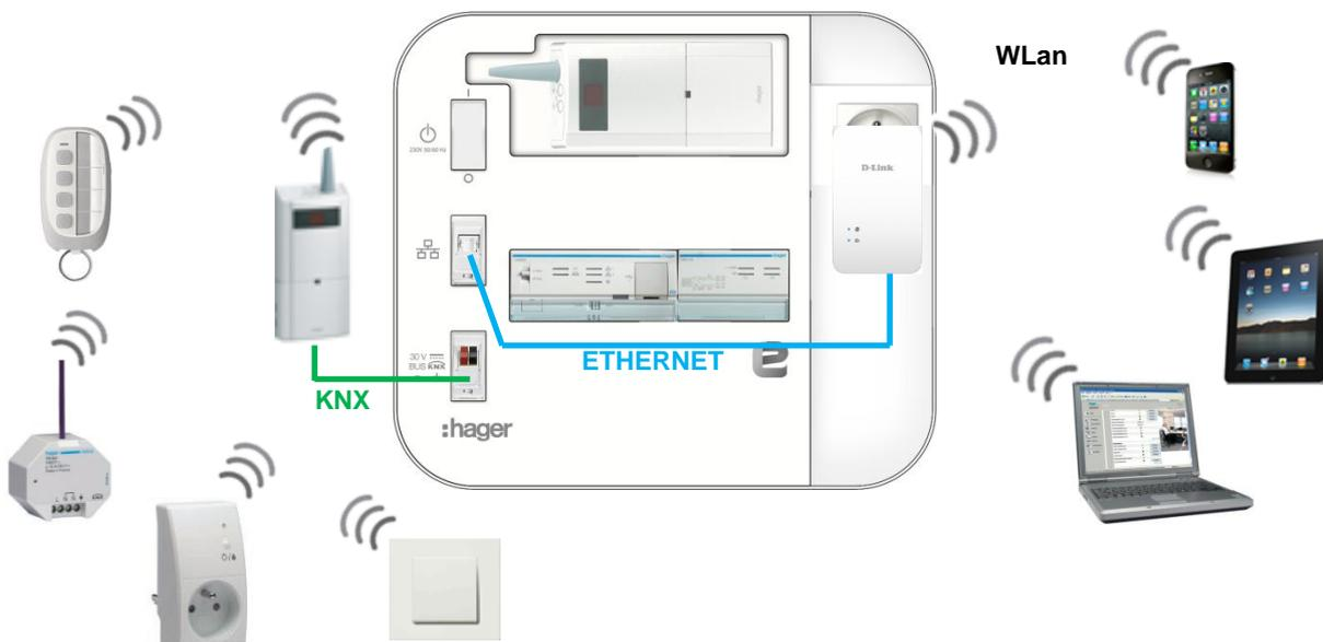
In der Installation sind nur Funk-Produkte vorhanden. Zur Parametrierung dieser Produkte muss ein Medienkoppler an das Konfigurationstool angeschlossen werden.
