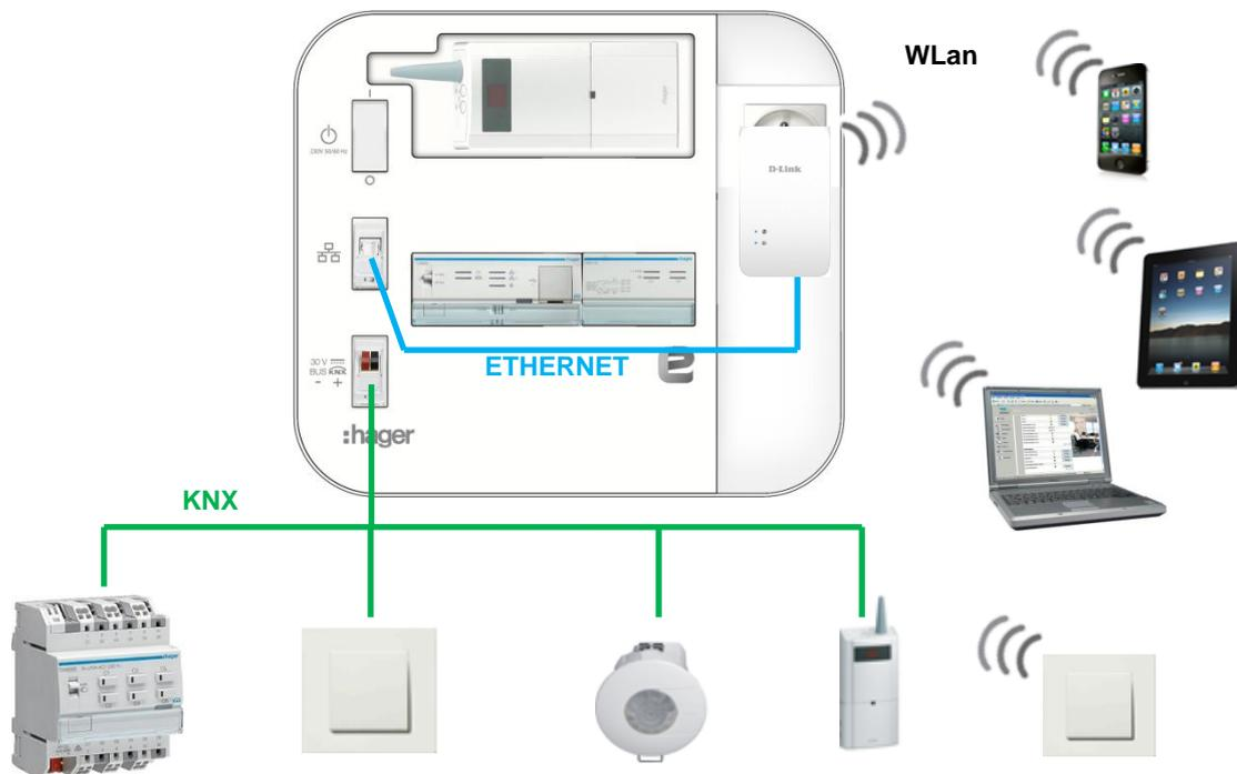
In der Installation sind funk- und drahtgebundene Produkte vorhanden. In diesem Fall wird die Verbindung durch den in der Installation bereits vorhandenen Medienkoppler hergestellt, der für die Verbindung zwischen dem Konfigurationstool und der Funkverbindung sorgt.
