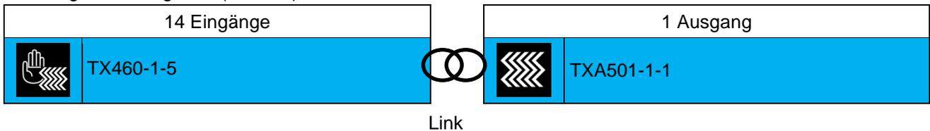
Es ist ebenfalls möglich, mithilfe eines Eingangskontakts einen Heizungsmodus an das Thermostat zu senden. Dazu muss ein Link zwischen zwei Eingängen angelegt werden.
