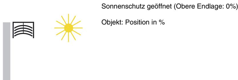
Soll die untere Endlage angefahren werden, so wird dies dem Jalousieaktor als Sonnenschutzstellung 100% vorgegeben bzw. das Erreichen der unteren Endlage (D. h. Sonnenschutz vollständig geschlossen). Dies wird über diesen Wert gemeldet. Wird eine Jalousie aus der oberen Endlage herab gefahren, so kippen die Lamellen zuerst in eine fast senkrechte Lage, und der Sonnenschutz fährt mit geschlossenen Lamellen bis in die untere Endlage.
