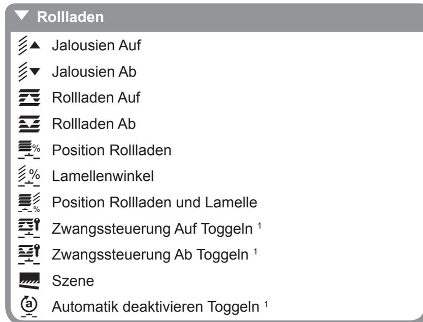
Bild 35: Funktionsübersicht **Rollladen**
