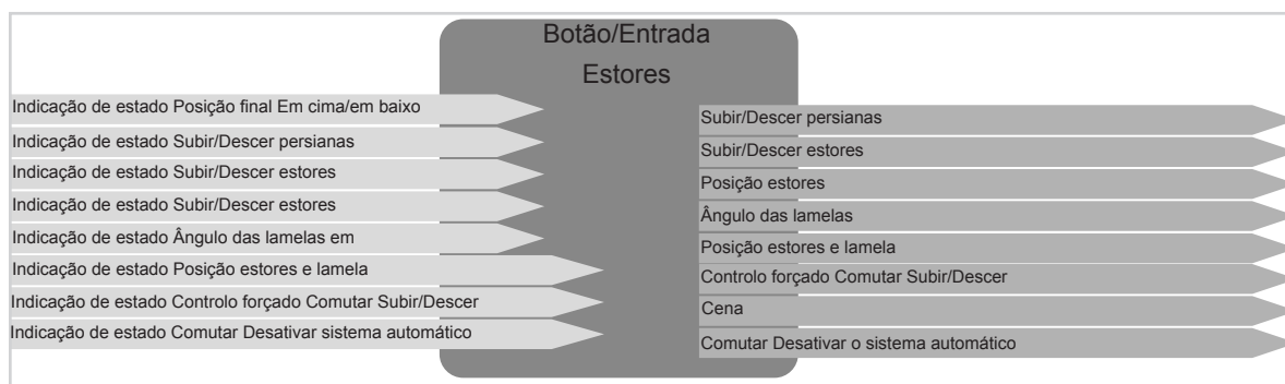
Figura 5: Sinais de entrada/saída Função estores
