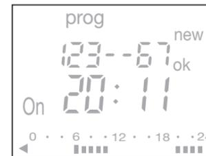
1. Wählen Sie den prog Modus anhand der Taste menu mit anschließender Betätigung von ok aus. Die Anzahl der unbelegten Programmierschritte wird einige Augenblicke lang angezeigt.
