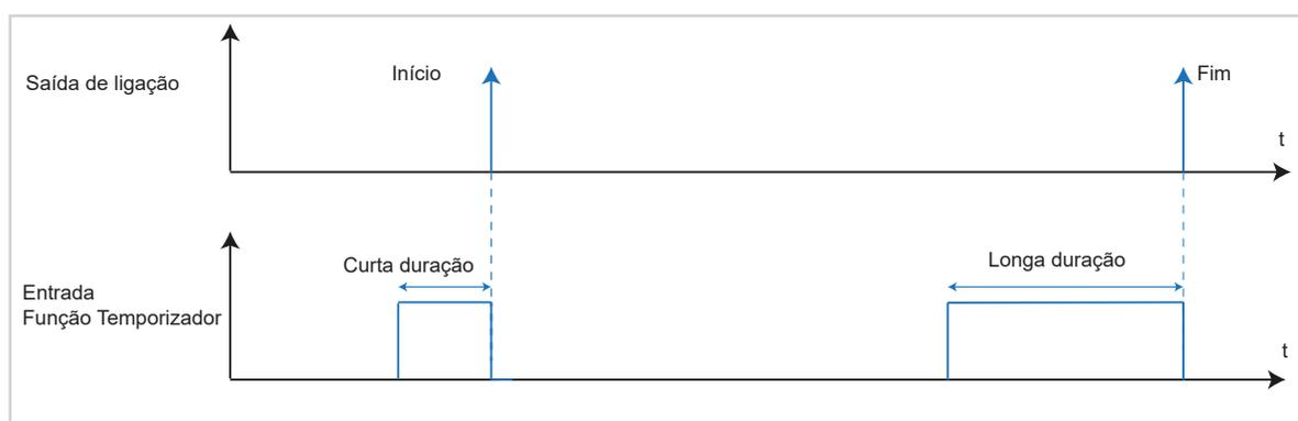
Figura 21: Diagrama de sinal e tempo Temporizador
