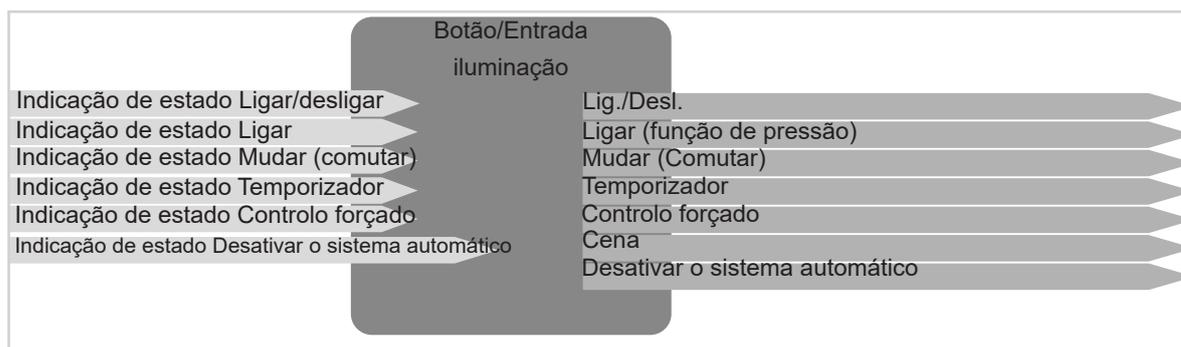
Figura 4: Sinais de entrada/saída Função iluminação
