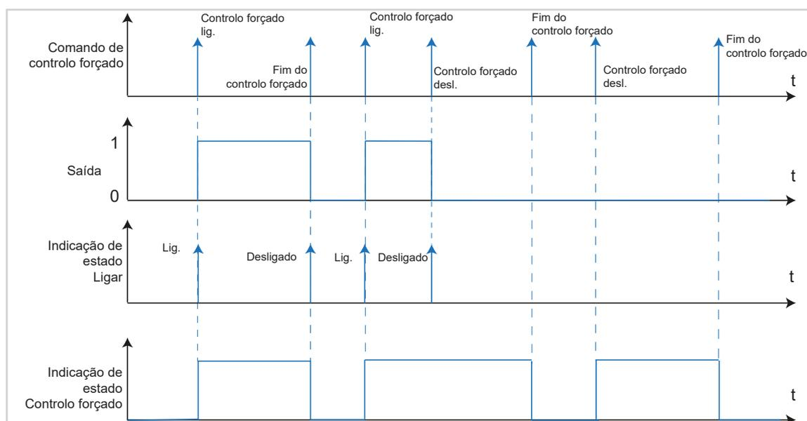
Figura 24: Diagrama de sinal e tempo Controlo forçado
