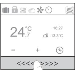
Bild 4: Slider-Funktion
