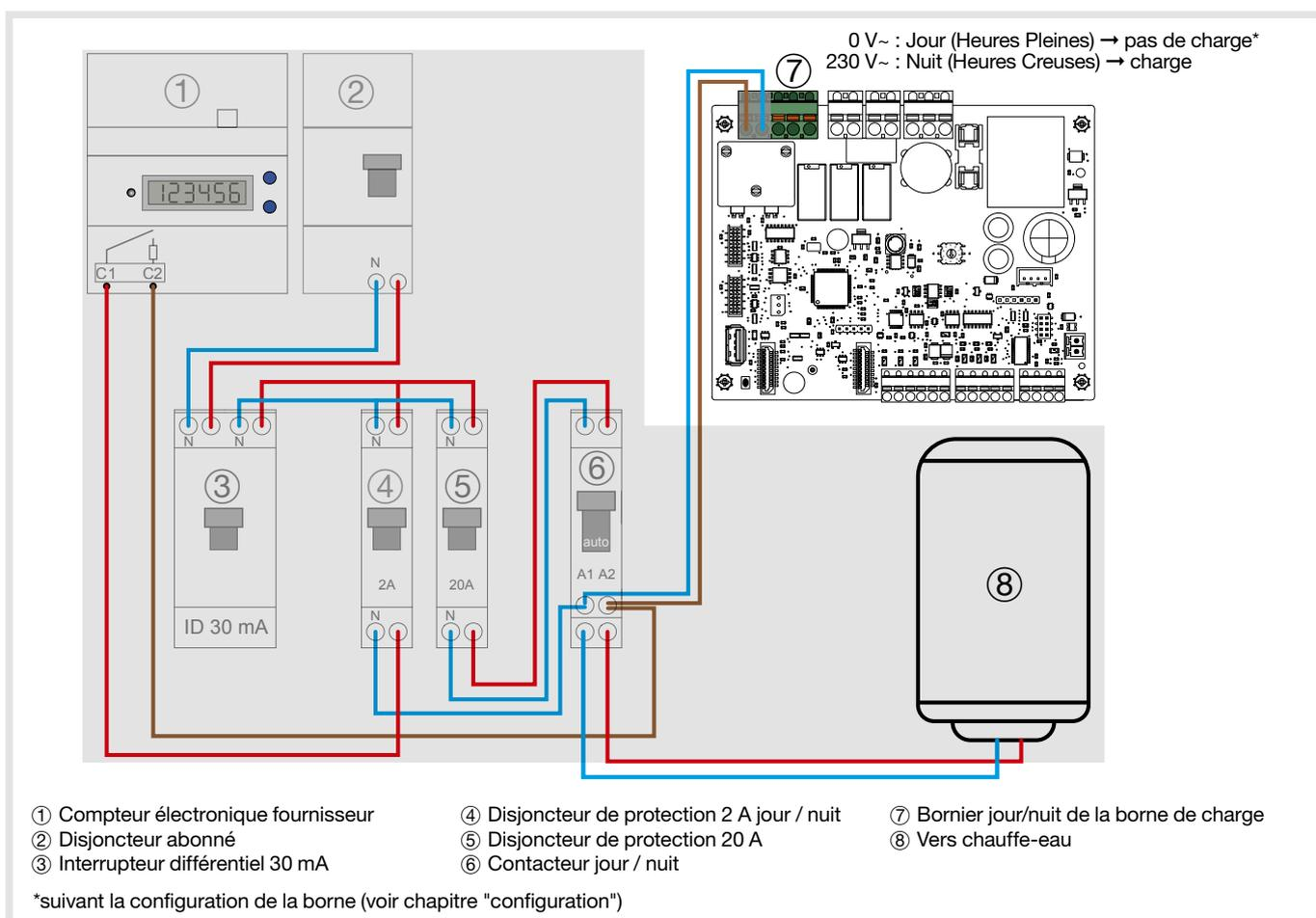
Dans le cas où cette installation n'est pas en place, rajouter le disjoncteur de protection 2 A selon le schéma ci-dessous :
