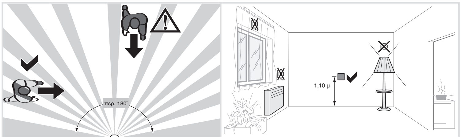
Εικόνα 4: Θέση εγκατάστασης ανιχνευτών κίνησης και προσανατολισμός κίνησης
