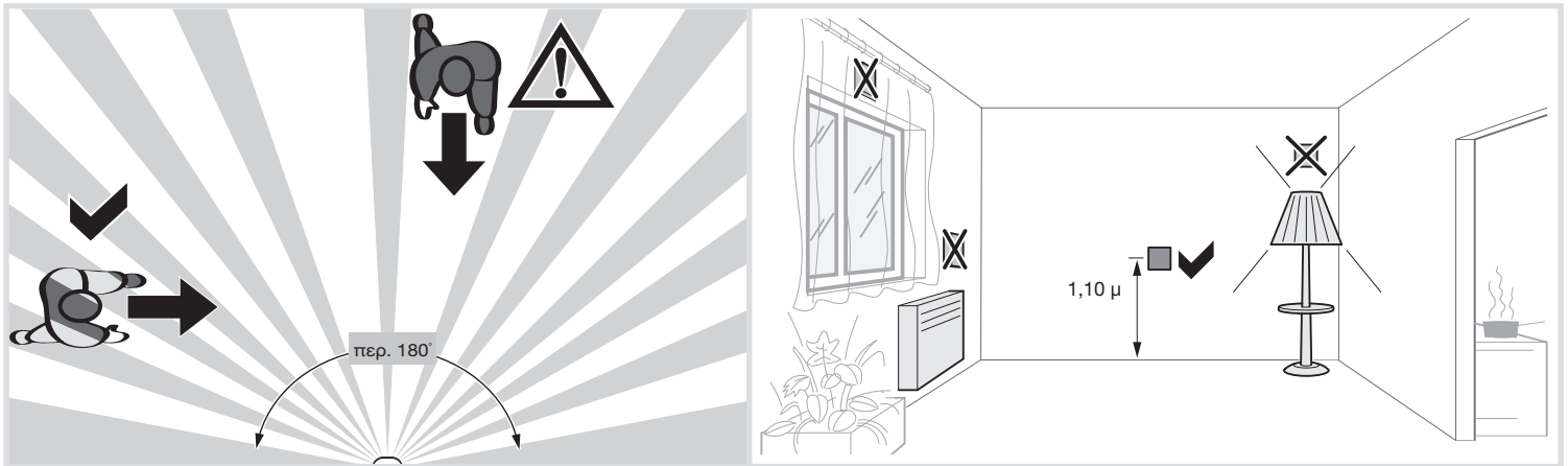
Εικόνα 4: Θέση εγκατάστασης ανιχνευτών κίνησης και προσανατολισμός κίνησης
