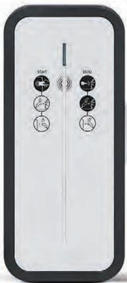
**Die Ladestation witty solar:** äußerst robustes Gehäuse (Schutzklassen IK10, IP55), Mode-3-Steckdose nach DIN EN 61851, Authentifizierung über RFID. Über den Energiemanagement Controller können bis zu 3 Ladestationen vernetzt werden.
