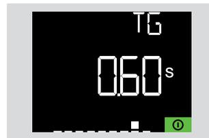
Einstellwert der Zeitverzögerung zur Erdschlussüberwachung.
