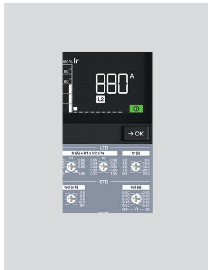
Durch Drehen der Einstellräder werden die Einstellwerte der Parameter angezeigt.
