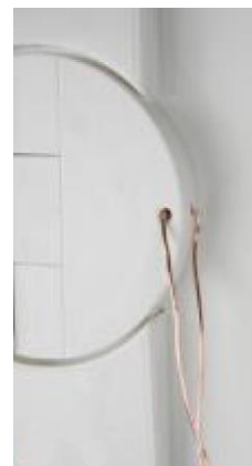
Beispiel: Anbringung eines Plombierdrahts beim FZ598N
