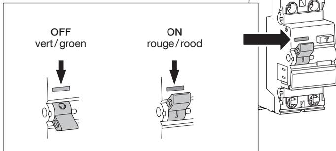
TEST et visualisation défaut différentiel : lors de l'action sur le bouton test, l'interrupteur différentiel doit déclencher.
