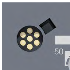
Port d'interface de maintenance (MIP)
