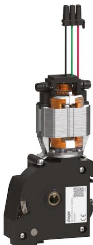
Le moteur de chargement sert à recharger automatiquement le ressort de fermeture. L'utilisation du moteur permet de s'affranchir d'un rechargement manuel et de disposer d'un ressort toujours chargé en fonctionnement normal.
