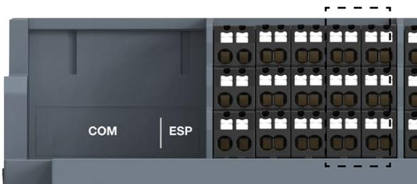
Logements des connecteurs de sorties d'alarme
