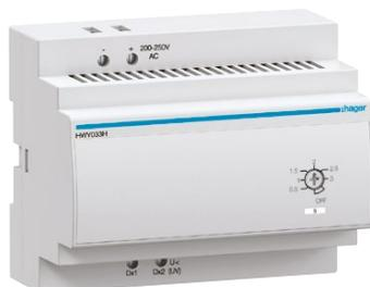
Le retardateur UVTC permet de temporiser le déclenchement de la bobine à manque de tension UV afin de remédier à une chute de tension transitoire inférieure à 0,5 secondes. Il peut être monté sur un rail DIN.
