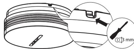
2. Dégager le détecteur de son support en le tournant dans le sens inverse des aiguilles d'une montre.
