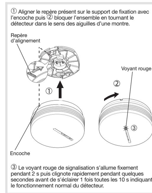
① Aligner le repère présent sur le support de fixation avec l'encoche puis ② bloquer l'ensemble en tournant le détecteur dans le sens des aiguilles d'une montre.
