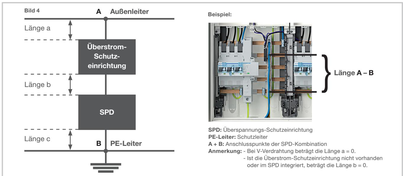
Die Anschlusslänge ist nach Norm definiert als die Verbindung vom elektrischen Abzweig aus der Anlage (Bild 4, Anschluss A) im Bereich der Einspeisung zum Überspannungsableiter sowie vom Überspannungsableiter zum Schutzleiter (Bild 4, Anschluss B).
