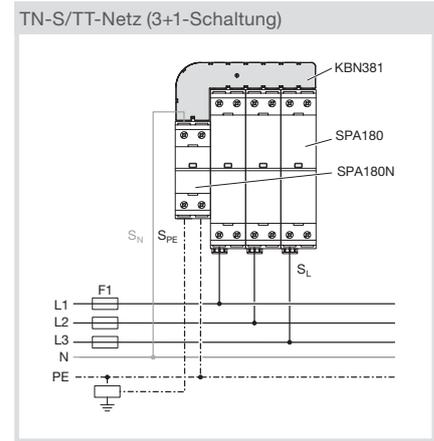
Für das TN-S-Netz kann die 4+0- oder die 3+1-Schaltung genutzt werden. Die 3+1-Schaltung gewährleistet einen niedrigeren Schutzpegel zwischen den Außenleitern und dem Neutralleiter. Dies belastet die angeschlossene
