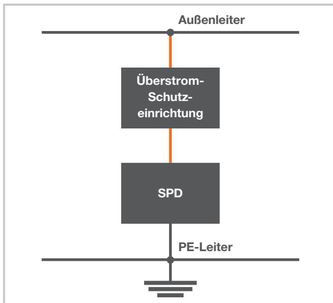
Bei der Wahl des Leiterquerschnitts sind die Vorgaben aus Abschnitt 433.3.1 b) der VDE 0100-430 zu beachten. Demnach müssen die Verbindungsleitungen zwischen der Überspannungs-Schutzeinrichtung und den Außenleitern entsprechend dem prospektiven Kurzschlussstrom ausgelegt werden und folgende Mindestquerschnitte aufweisen:
