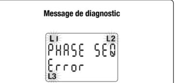
La séquence de câblage (L1-L2-L3) est erronée. Les icônes L1, L2 et L3 clignotent. Inverser les fils de tension de 2 phases (phase 1 <-> phase 2 ou phase 2 <-> phase 3). Sinon, en appuyant sur le bouton « OK » pendant au moins 5 secondes, le message disparaît jusqu'au prochain redémarrage.
