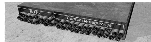
Para determinar a capacidade máxima de preenchimento, é necessário saber o volume ocupado pelo conjunto dos cabos. O quadro seguinte indica, aproximadamente, o número máximo de cabos que podem ser instalados nas calhas. As secções e diâmetros de cabos podem variar de fabricante para fabricante, pelo que este quadro deve ser considerado como meramente indicativo:
