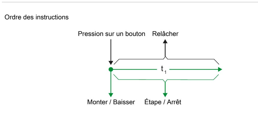
Figure 7: Concept de commande « Haut/bas - Pas à pas
