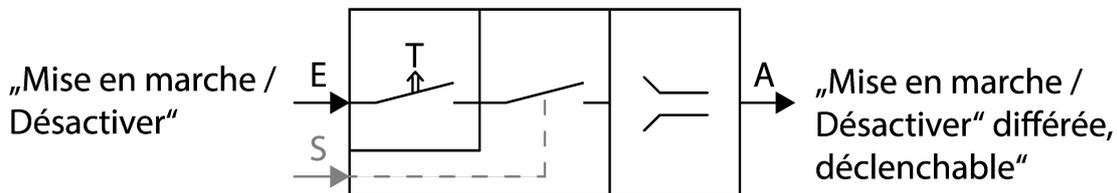
Figure 20: Représentation schématique « fonction cage d'escalier »
