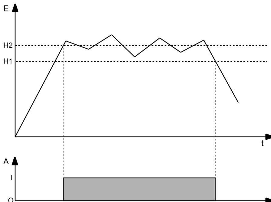
Figure 27: Exemple d'une évaluation d'hystérésis grâce à la valeur seuil supérieure et à la valeur seuil inférieure
