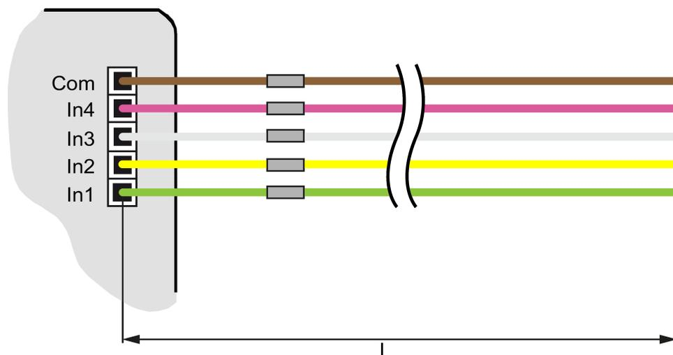
Figure 3: Longueur maximale de câble
