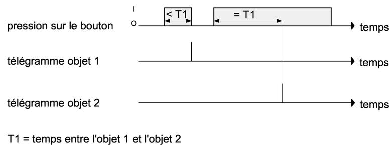
Figure 10: Exemple de concept de commande « Objet 1 ou objet 2 »
