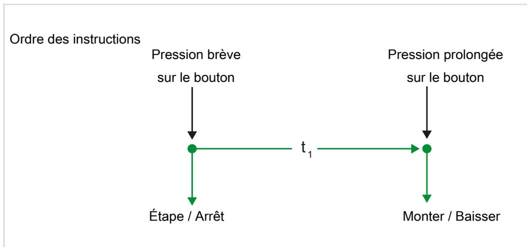
Figure 8: Concept de commande « pas à pas - haut/bas
