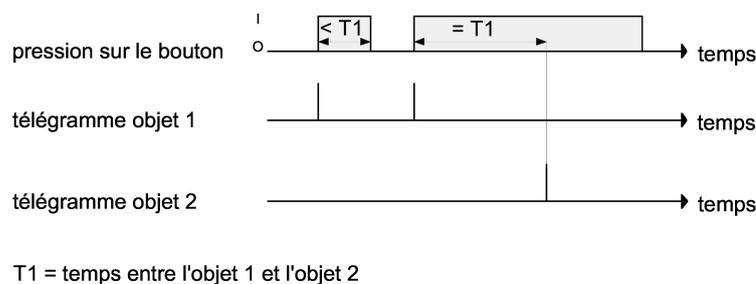
Figure 11: Exemple de concept de commande « Objet 1 et objet 2 »
