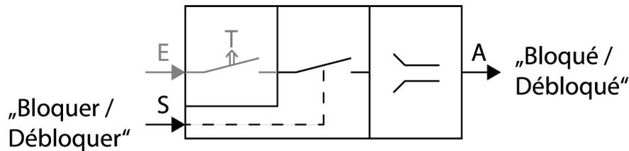
Figure 21: Représentation schématique de la « fonction de blocage »
