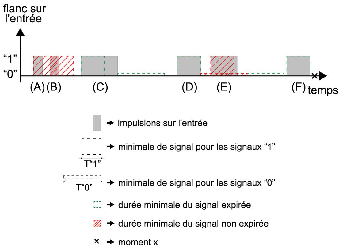
Figure 15: Exemple de réglage de la durée minimale de signal
