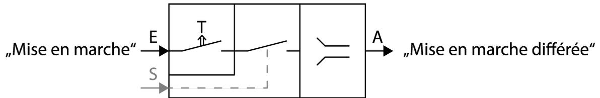
Figure 17: Représentation schématique « Enclenchement retardé »
