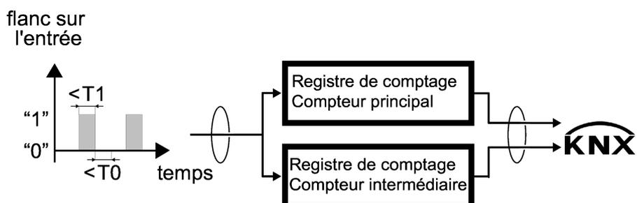
Figure 12: Schéma fonctionnel du compteur d'impulsions
