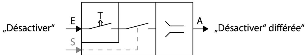
Figure 18: Représentation schématique « Arrêt différé »
