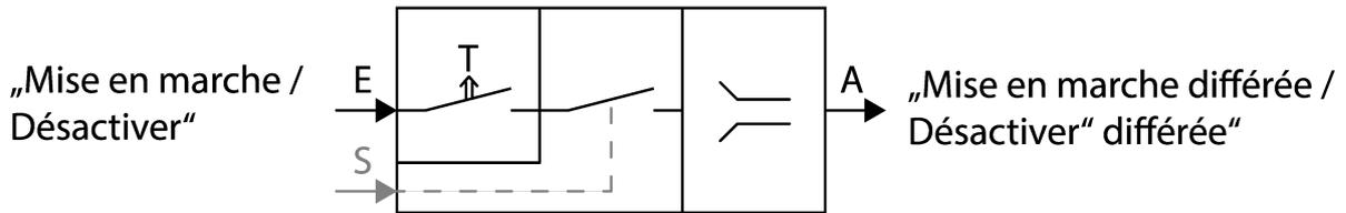
Figure 19: Représentation schématique « Enclenchement et déclenchement temporisés »
