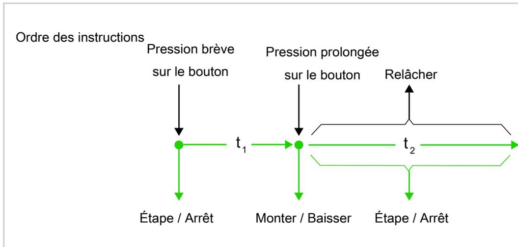
Figure 6: Concept de commande « Pas à pas Haut / Bas - Pas à pas »
