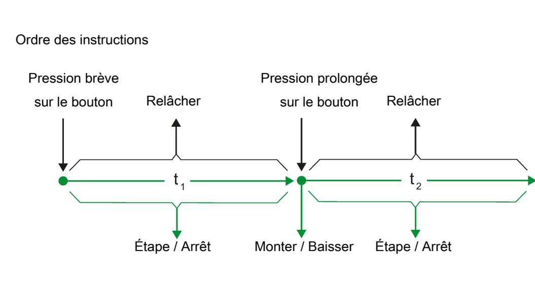
Figure 9: Concept de commande « haut/bas - pas à pas »
