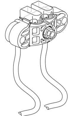
! La borne de raccordement à perforation d'isolant n'est pas réutilisable une fois la vis de serrage à tête fusible rompue.
