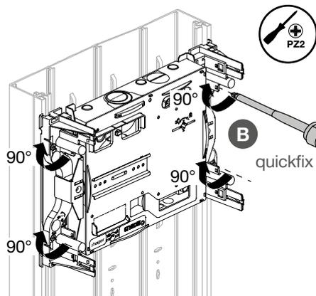
! Jeu de vis "quickfix" pour la fixation sur la goulotte incluse dans la goulotte Gamma.
