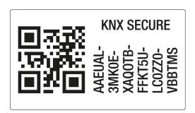
Cette clé n'est utile que pour la première mise en service du produit. Si le produit doit être réutilisé dans une autre installation, un retour usine du produit est alors nécessaire. Une fois le produit de nouveau dans sa configuration d'usine, il peut être reconfiguré.
