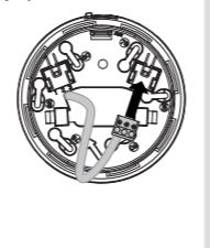
7 Zet de kabel vast met de tie-wrap uit het zakje met toebehoren.
