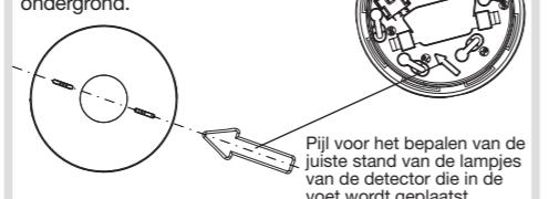
Pijl voor het bepalen van de juiste stand van de lampjes van de detector die in de voet wordt geplaatst.
